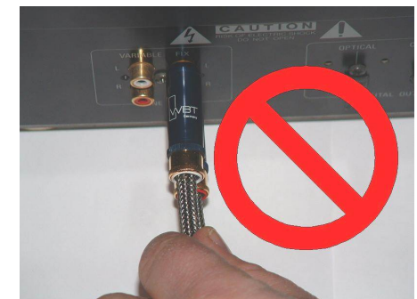
Foto4: Niet aan de kabel lostrekken.
